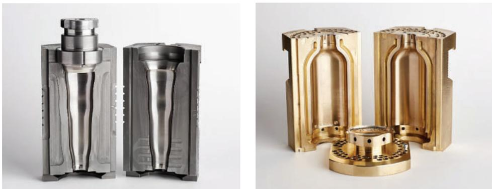
Рис. 36. Черновая (слева) и чистовая (справа) формы для формования бутылок методом blow-blow
