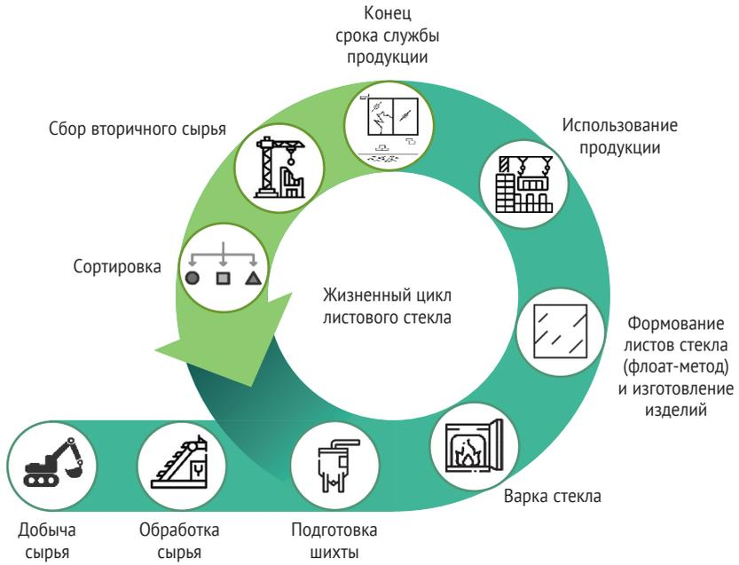
Рис. 51. Схема жизненного цикла листового стекла
