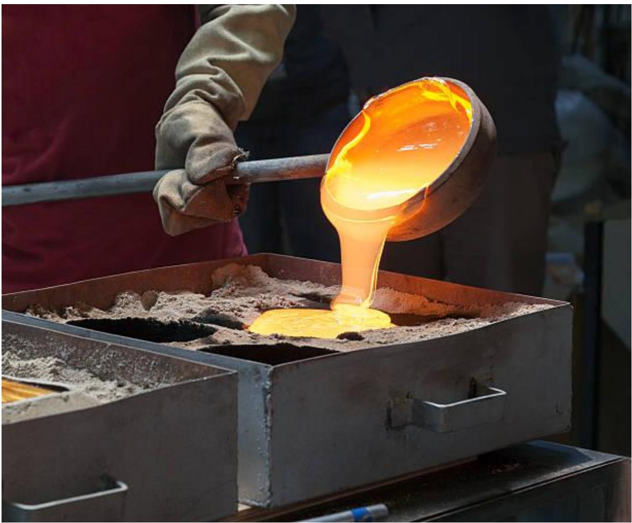
Способ литья по выплавляемым моделям применяется для изготовления металлических изделий — как черных, так и цветных. И только для металлов, проявляющих повышенную склонность к реакции в жидкой фазе (таких как титан), приходится делать матрицы из других составов.
