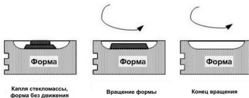
Рисунок 2.4.2 — Процесс вытягивания для формования изделий из стекла [11]
