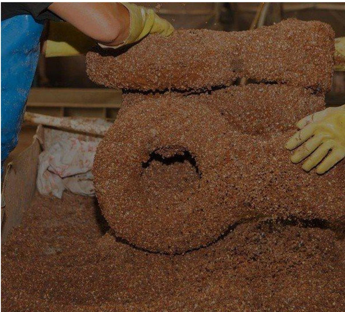
Связующим выступают гидролизованные силикаты, в качестве жаростойкой обсыпки берут кристаллики электрокорунда или кварца. Материалы для производства оболочковых форм отличаются высокой прочностью, низкой гигроскопичностью и отличной газопроницаемостью.
