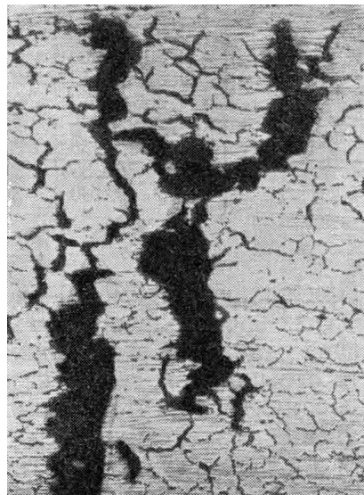
Рис. 12.11. Структура медной трубы, разрушившейся от «водородной болезни»
