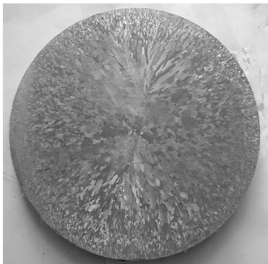
Рис. 13.28. Макро- (а) и микроструктура (б) теллуровой бронзы. На фотографии микроструктуры видны зерна меди и включения \text{Cu}_2\text{Te}
