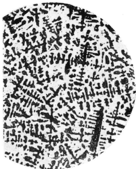
Рис. 13.4. Микроструктура литой оловянной бронзы с 5% Sn. Видны темные оси дендритных зерен бедного оловом твердого раствора. Промежутки между осями – твердый раствор, обогащенный оловом
