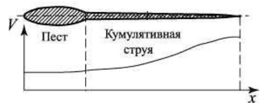
Рис. 4.11. Вид кумулятивной воронки после схлопывания с разделением на струю и пест; на графике приведено распределение скоростей
